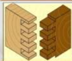
Соединение на открытый прямой шип
